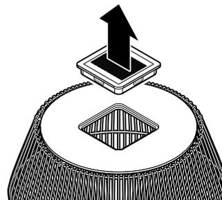
▷ Zum Herausnehmen greifen Sie **von unten** in das Untergestell und drücken Sie das Solarmodul nach oben heraus.
