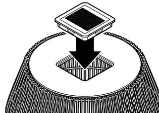
▷ Zum Einsetzen stecken Sie das Solarmodul **von oben** in die Tischplatte.
