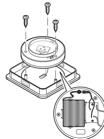
3. Lösen Sie die Schrauben auf der Unterseite des Solarmoduls mit einem Kreuzschlitzschraubendreher und nehmen Sie die Abdeckung ab. Achten Sie dabei darauf, keine Kabel abzureißen!
